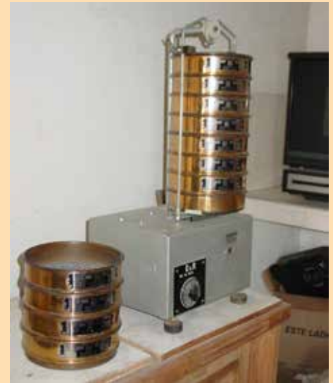
Equipo para la medición de la granulometría de los agregados, parte integral del control de calidad de la empresa.
