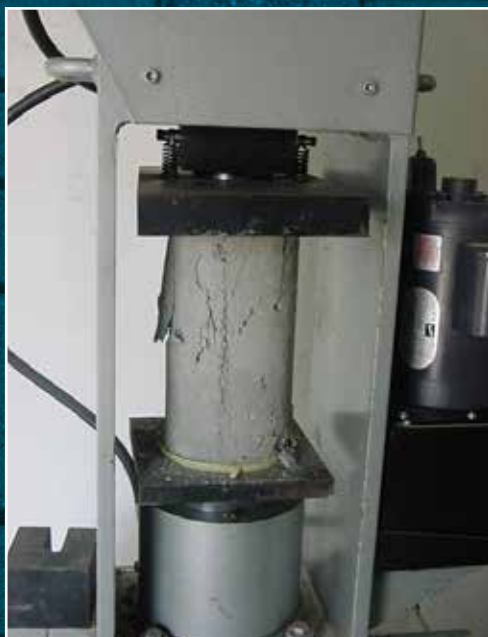
Ensayo a la compresión de cilindros
