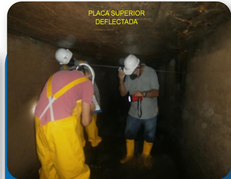
Medición de las deformaciones en la placa superior
