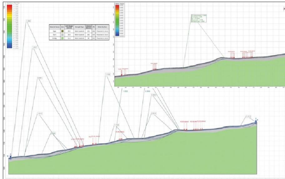
Figura 226. Análisis de Estabilidad de la Sección H-H' en la Condición no saturado y Con Sismo
